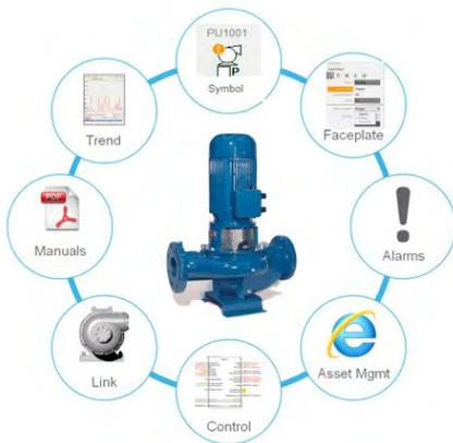
O modelo representa o equipamento físico, contendo todos os diferentes pontos de vista do equipamento: lógica de controle, representação gráfica, aquisição de dados, alarmes, tendências, segurança do sistema, controle de acesso, interfaces externas, etc.
